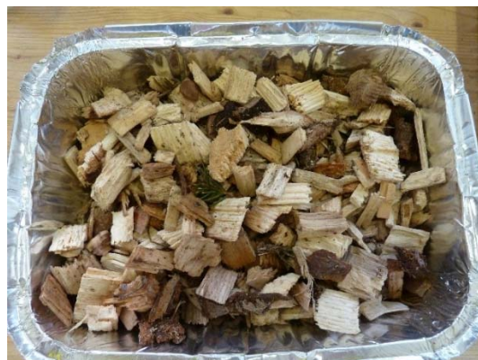
Abbildung 10: Vorbereitung der Probe für die Ofentrocknung.
