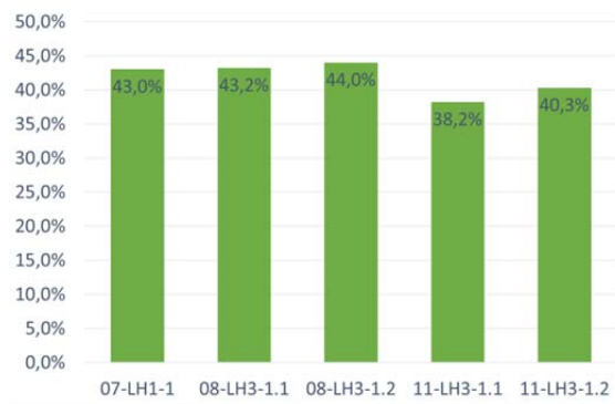
Abbildung 12: Proben vom gleichen abgedeckten Stapel, die in drei verschiedenen Kampagnen zerkleinert wurden. Die Niederschläge waren für die drei Werte auf der linken Seite deutlich höher.
