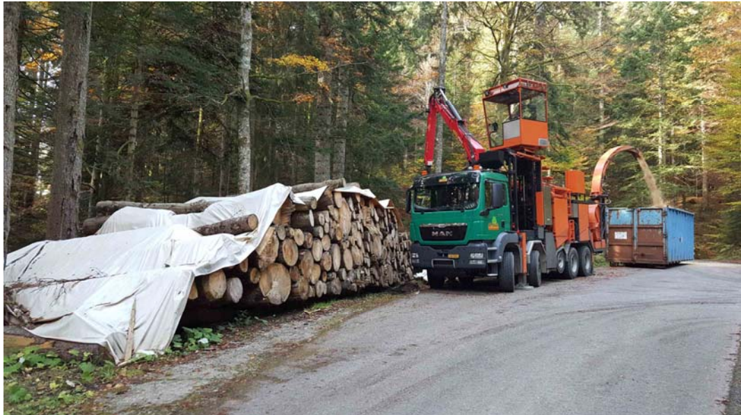
Abbildung 6: Herstellung von Waldhackschnitzeln in der Region Charmey aus einem Stapel von mit Papier bedecktem Stammholz.
