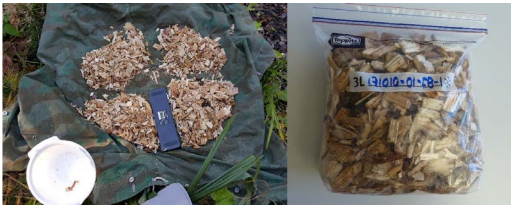
Abbildung 8: Beispiel für die Entnahme und Abfüllung einer Hackschnitzelprobe. Sechs Proben werden gemischt und ein Teil davon im Beutel verpackt. Die Probe wird noch am selben Tag versandt, damit die Analyse des Wassergehalts in den darauffolgenden Tagen durchgeführt werden kann. Das Fassungsvermögen des Beutels beträgt drei Liter und das Gewicht der Hackschnitzel weniger als 1 kg.
